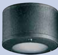
Deckenaufbaustrahler, IP54, Aluminium, Glas satiniert, Ø 12 cm, H. 7 cm, LM 60 W, G9
