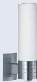
Wandleuchte , IP44, Edelstahl, Glas weiß, Soft-Lichtstart, inkl. Bewegungsmelder 240° mit 180° Öffnungswinkel, H. 42,6 cm, B. 10,2 cm, Ausl. 17,7 cm, 2x40 W, G9, HV
