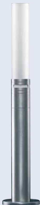
Pollerleuchte , IP44, Edelstahl, Glas weiß, Soft-Lichtstart, inkl. Bewegungsmelder 360° mit 20° Öffnungswinkel, H. 103,8 cm, B. 10,2 cm, auch als Podestleuchte verwendbar, Standrohr zweiteilig, der untere Teil ist abnehmbar, 3x40 W, G9, HV
