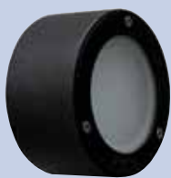
Wand- und Deckenleuchte, IP65, Aluminium, Glas satiniert, Ø 12 cm, H. 7 cm, LM 9 W, GX53, 230V
