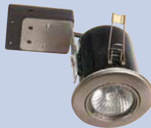
Einbaustrahler, IP20, Stahl V4A, schwenkbar, Ø 8,8 cm, ET. 11,5 cm, DA. 7,4 cm, LM 20 W, GU10, HV
